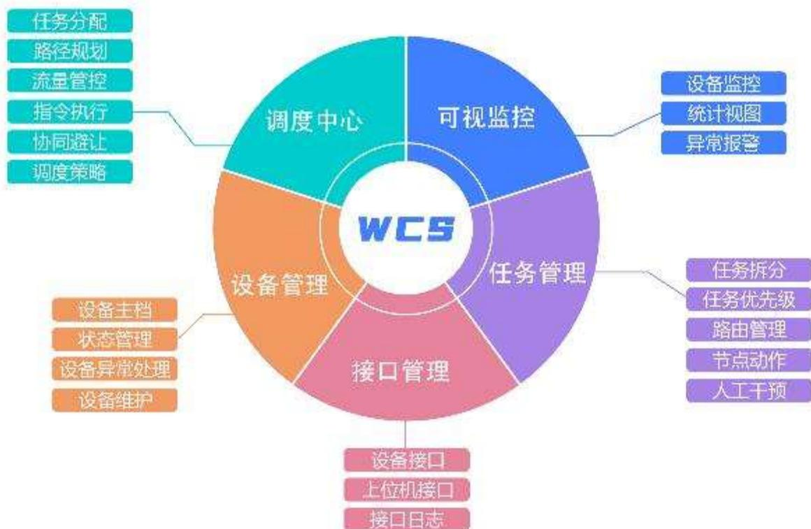
**WCS系统**全称是仓库控制系统 (Warehouse Control System), 调度系统。其介于自动化立体仓库管理系统与控制设备之间, 通过制定内部协议, 连接管理系统与PLC控制系统。自动化立体仓库的管理与监控将为对自动化立体仓库进行调度管理, 对各种物流设备进行控制。通信进程完成管理/监控系统与各种物流设备的通讯, 物流进程根据下位机下发运输申请、出入库申请, 分配货物的货位, 并生成相应的任务指令。调度进程根据调度规则将任务进行排队, 并按优先级发送命令。
